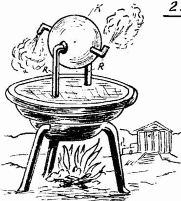
Abb. 4. Heron's Reaktions-Maschine.
