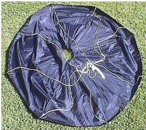
Das Foto zeigt den bereits fertigen Fallschirm ausgebreitet. Der Durchmesser beträgt 1,20 m. In der Mitte sieht man die Stabilisierungsöffnung mit 20 cm Durchmesser, deren Kanten mit der Nähmaschine umsäumt sind.
